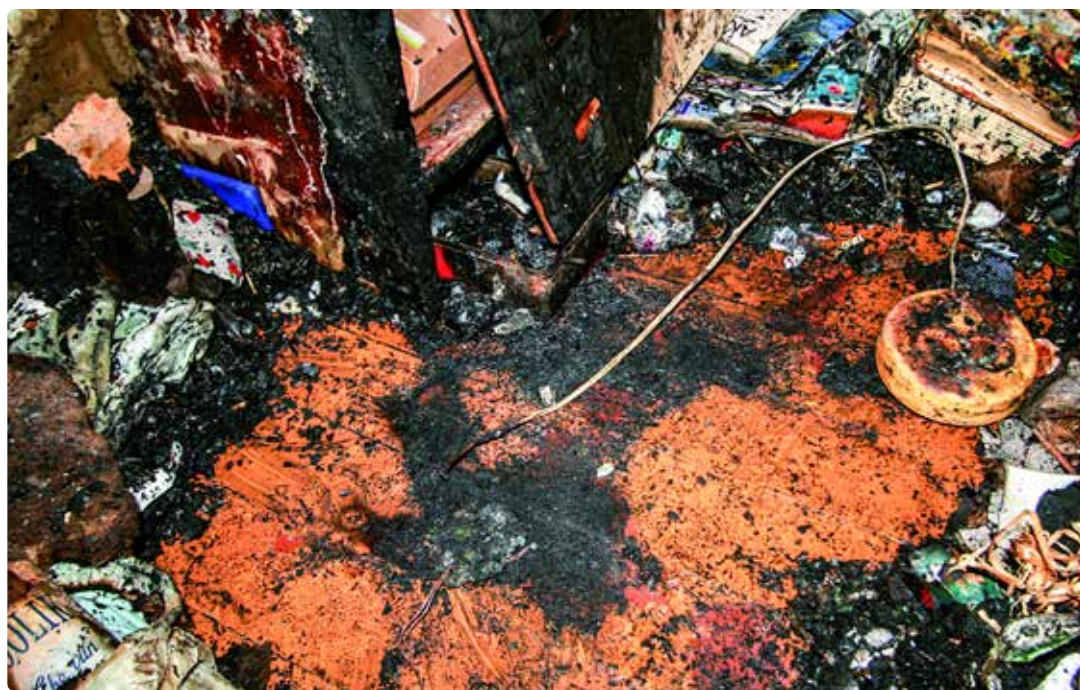
Nõukogudeaegne pistikujuhe ei ühildu kaasaegsete ja võimsamate seadmetega. Pikendusjuhtmega oli pikendatud pikendusjuhtmeid. Foto: Tanel Sepajõe
