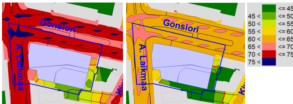
Joonis 4 Perspektiivne olukord koos kavandatava hoonega 2038. a liiklussageduse prognoosi järgi. Vasakul päevane (Ld) ja paremal öine (Ln) müratase 2 m kõrgusel maapinnast, dB(A).
