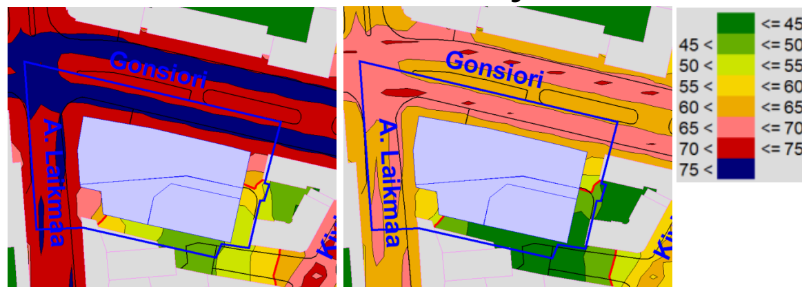
Joonis 3 Olemasolev olukord koos kavandatava hoonega 2018.a liiklussageduse andmete järgi. Vasakul päevane (Ld) ja paremal öine (Ln) müratase 2 m kõrgusel maapinnast, dB(A).
