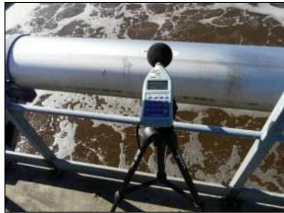
Joonis 20. Aeratsioonisüsteemide müra mõõtmised Paljassaare reoveepuhastusjaamas.
